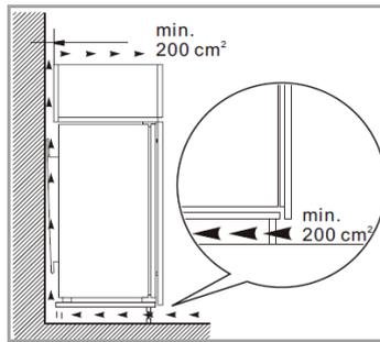
Für die Be- und Entlüftung ist an der Geräterückseite ein Abluftkanal von ca. 38 mm Tiefe vorzusehen.
